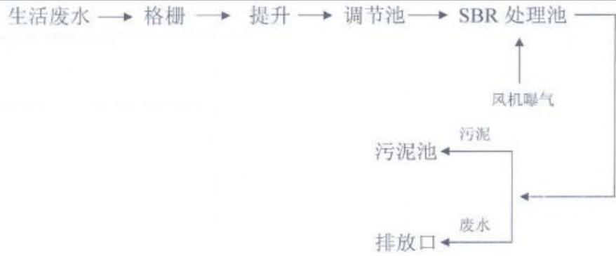
图2 自建生活污水处理设施工艺流程图
