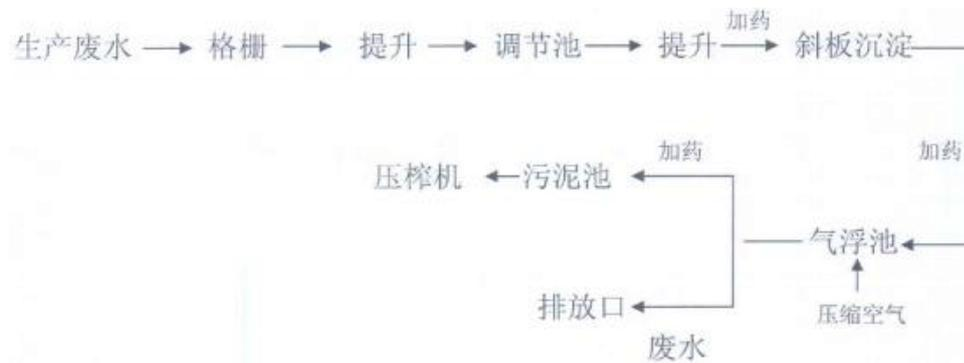
图3 自建生产废水处理设施工艺流程图
